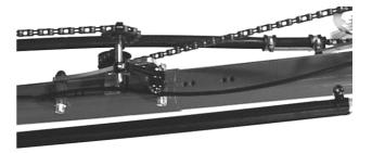
Ist die richtige Position für den Fahrer gefunden, so sollte die Kettenlänge angepasst werden. Je Lochpaar um das die Umlenkrolle versetzt wurde sind vier Gliedpaare der Kette zu entfernen.
