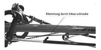
Klemmung der Lenkübertragungsstange mit einem 5mm Inbusschlüssel lösen, Vorderrad und Lenker gerade stellen und Schraube festziehen - die Lenkung ist gesichert.
